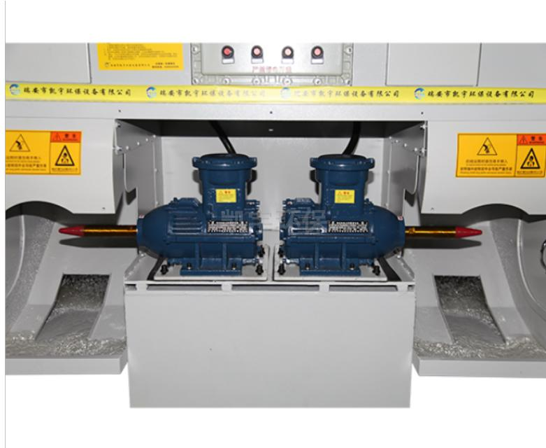
湿式除尘抛光机设备选购要点：**\*除尘效率：**湿式除尘设备效率高不高是选择的一项z重要的性能指标，一定状态下的气体流量特定粉尘污染物，气体的状态对捕集效率都有直接影响。**\*操作弹性：**任何操作设备，都要考虑到它的负荷、在气流量超过或低于设计值时对捕集效率的影响如何，同样还要掌握含尘浓度不稳定或连续地高于设计值时将如何进行操作。**\*疏水性：**湿式除尘设备对疏水性粉尘的净化效率不高，一般不宜用于设计值时将如何进行操作。**\*黏结性：**湿式除尘设备可净化黏结性粉尘，但应考虑冲洗和清理，以防堵塞。**\*腐蚀性：**净化腐蚀性气体时应考虑防腐措施。**\*耗水量：**除尘设备耗水多少，排出的污水处理，水的冬季防冻措施。**\*泥浆处理：**泥浆处理是湿式除尘设备必然遇到的问题，应当力求减少污染的危害程度。**\*运行和维护：**一般应避免在除尘器内部有运动或转动部件，注意气体通过流道断面过小时会引起堵塞。
